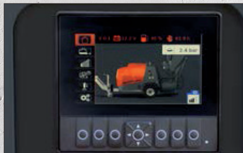
Neues überarbeitetes Bedienkonzept: Der Bediener kann alle notwendigen Informationen direkt von der Bedienstelle aus einsehen und einstellen.
