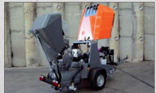
Das neuartige Haubenkonzept und das abnehmbare Rückteil ermöglichen eine hohe Zugänglichkeit zu allen wichtigen Service und Wartungspunkten
